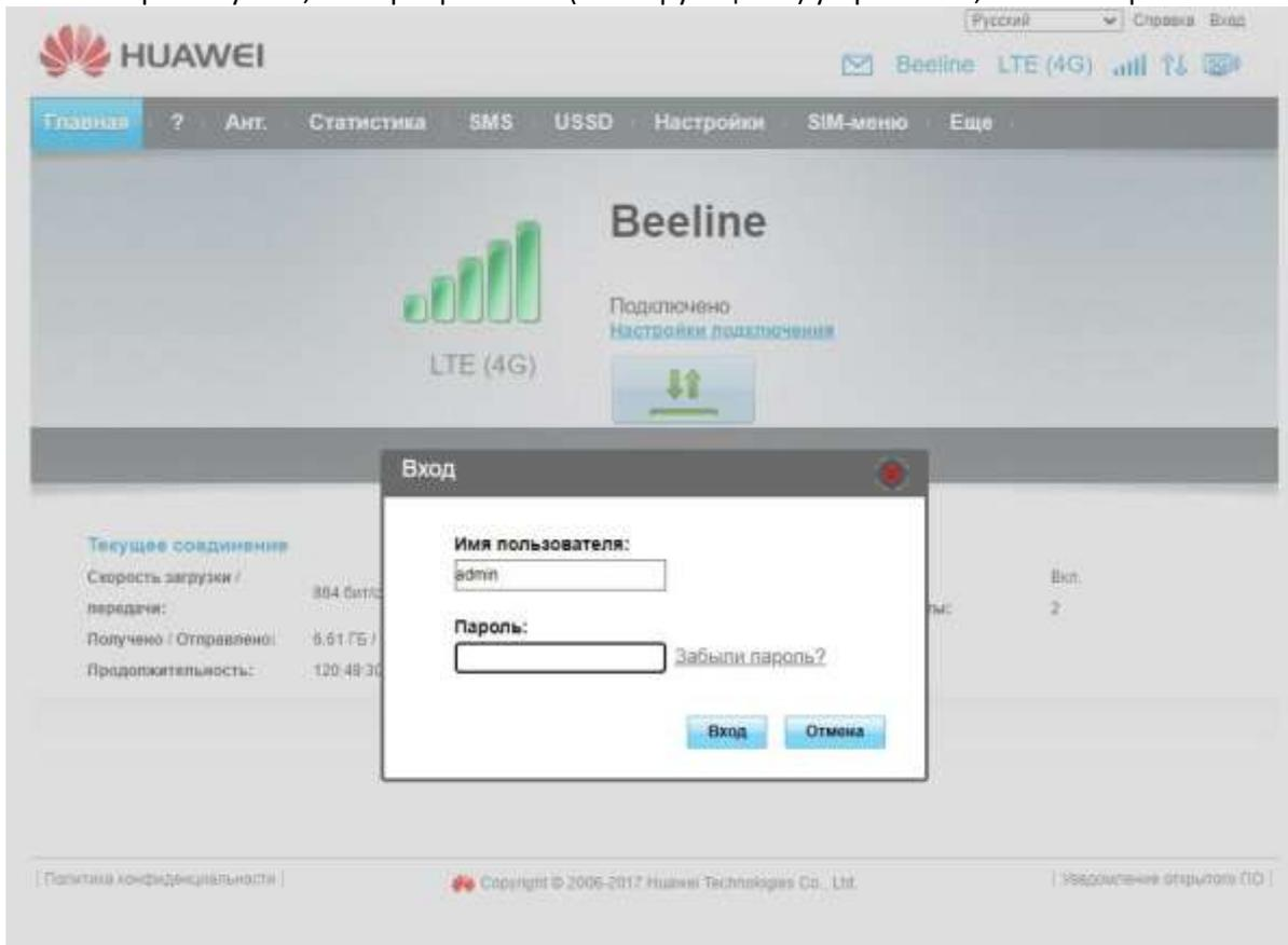
4. Мы находимся в интерфейсе (меню) модема\модема-роутера Huawei, нажимаем на кнопку "Статистика". Кнопка находится справа от вкладки "Главная", в разных версиях прошивки ее положение может отличаться.
